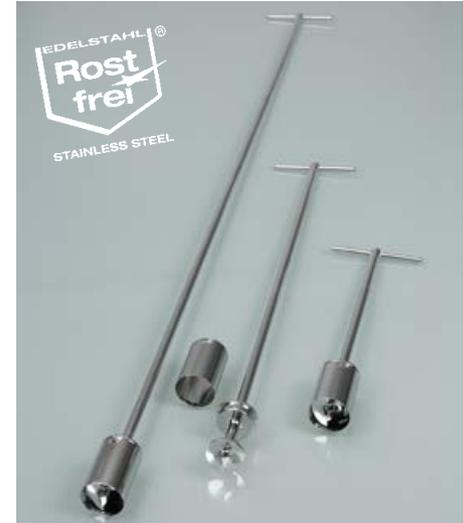
Пробоотборник предназначен для отбора проб замороженных, высоковязких, пастообразных и аналогичных по консистенции материалов. Режущая кромка в форме бура врезается при вращении в объём анализируемого материала.
